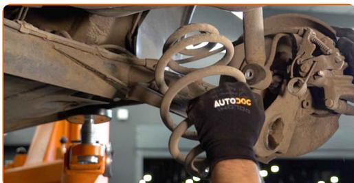
**16** Pulisci le sedi di montaggio della molla elicoidale. Usa una spazzola metallica. Usa lo spray WD-40.
