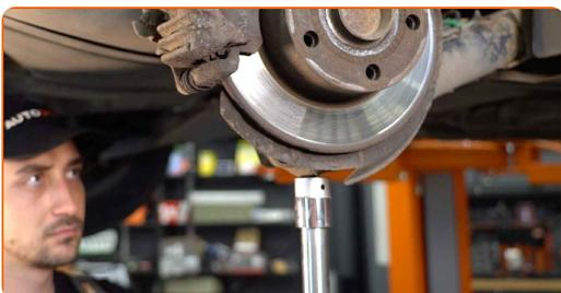
**19** Stringi l'elemento di fissaggio inferiore dell'ammortizzatore. Utilizza una chiave combinata N°16. Utilizza una chiave a bussola N°16. Usa una chiave dinamometrica. Serralo fino allo coppia di torsione di 50 Nm. +90°
