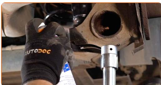
**24** Rimuovi il supporto da sotto la trave dell'asse posteriore.
