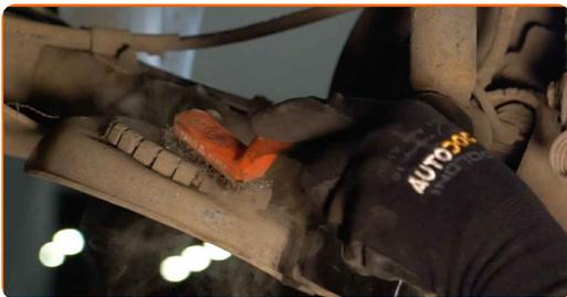
**17** Installa la molla elicoidale insieme ai montanti di gomma nelle sedi di montaggio.
