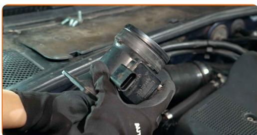
**10** Installare un nuovo sensore del flusso d'aria di massa.
