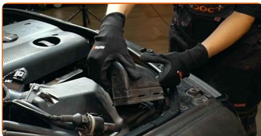
**4** Svitare gli elementi di fissaggio dello scudo termico dell'alloggiamento del filtro dell'aria. Usa un cacciavite Phillips.
