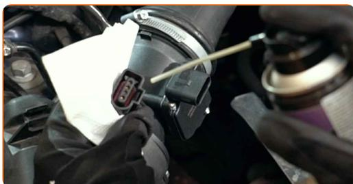
**14** Collegare il connettore del sensore del flusso d'aria di massa.
