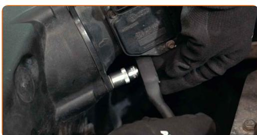
**9** Rimuovere il sensore del flusso d'aria di massa.
