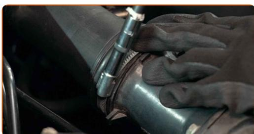
**8** Svitare gli elementi di fissaggio del sensore MAF (debimetro). Utilizza una chiave a bussola N°10. Usa una chiave a cricchetto.
