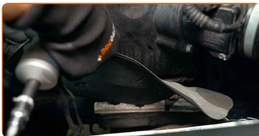
**6** Staccare il connettore del sensore del flusso d'aria di massa.
