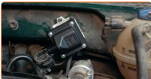
**10** Stringere gli elementi di fissaggio della bobina di accensione. Utilizza una chiave a bussola N°10. Usa una chiave dinamometrica. Serralo fino allo coppia di torsione di 7 Nm.
