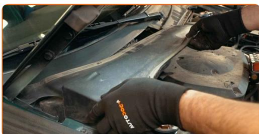
**15** Installa la guarnizione griglia sottoparabrezza.
