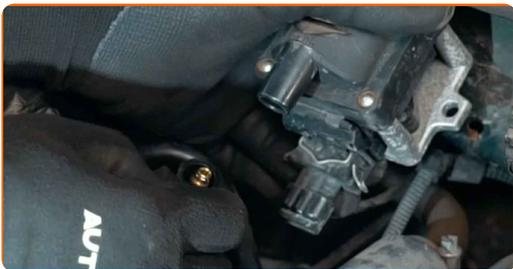
Sostituzione: bobina d'accensione - VW PASSAT Variant (3A5, 35I). AUTODOC raccomanda:
