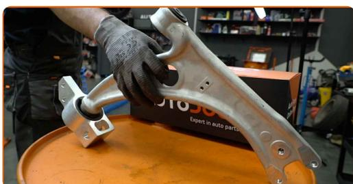
Sostituzione: braccio inferiore anteriore - VW Passat Variant (365). AUTODOC raccomanda:
