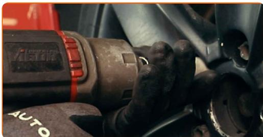
**20** Rimettere il veicolo per terra e, lavorando in ordine incrociato, serrare i bulloni di fissaggio delle ruote. Usa la chiave a bussola per dadi cerchio ruota n.17. Usa una chiave dinamometrica. Serralo fino allo coppia di torsione di 120 Nm.
