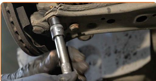
**55** Stringi gli elementi di fissaggio del giunto sferico. Utilizza una chiave a bussola N°13. Usa una chiave dinamometrica. Serralo fino allo coppia di torsione di 20 Nm. +90°
