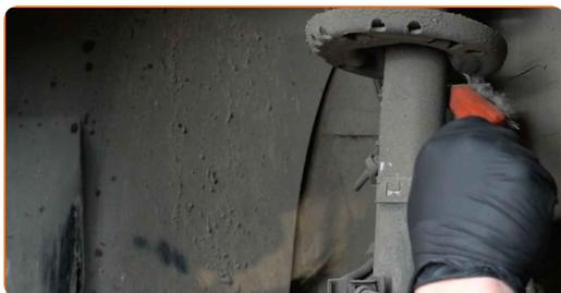
**14** Svita gli elementi di fissaggio che collegano il tirante della barra stabilizzatrice al puntone dell'ammortizzatore. Utilizza una chiave a bussola N°17. Usa una chiave a cricchetto.
