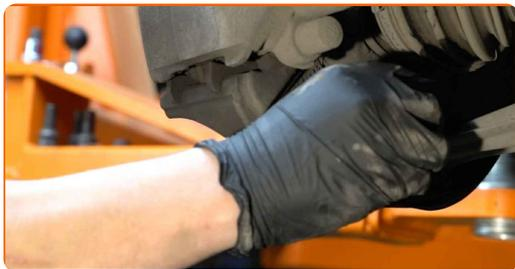
**25** Svita gli elementi di fissaggio che collegano l'albero di trasmissione al mozzo della ruota. Utilizza una chiave a bussola N°36.
