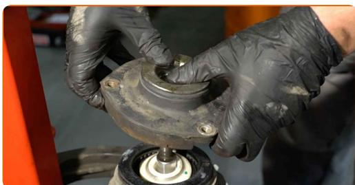
**Sostituzione: supporto ammortizzatore - VW PASSAT Tre volumi (32B).
