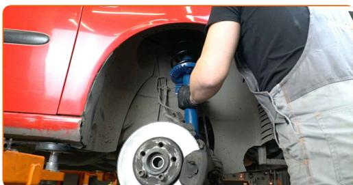
**46** Avvita l'elemento di fissaggio superiore del montante supporto ammortizzazione. Non lo serrare.
