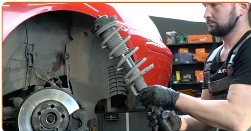
**33** Montare il supporto di ammortizzazione sul dispositivo speciale per la compressione delle molle.
