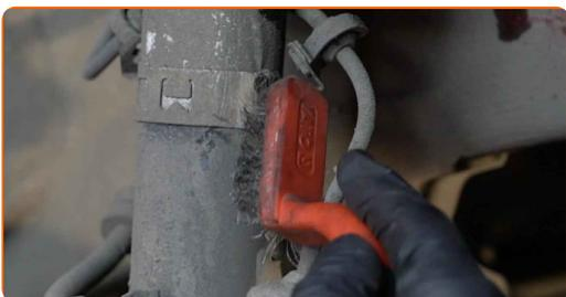
**17** Rimuovi il clip di ritenuta del tubo flessibile del freno.
