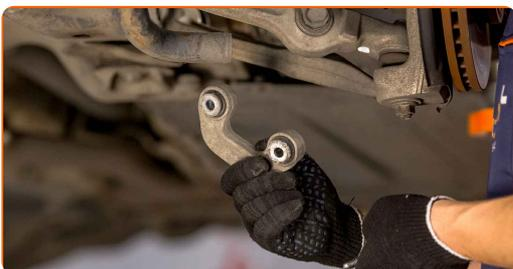
Sostituzione: biellette barra stabilizzatrice - VW PASSAT Tre volumi (32B). I professionisti raccomandano:
