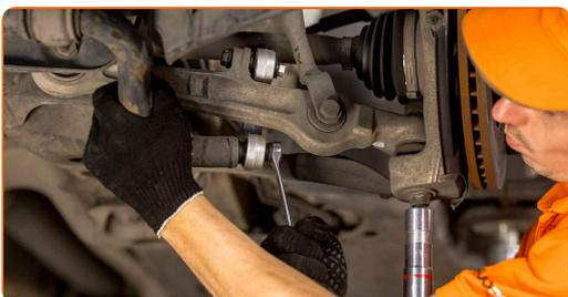
**15** Puntellare il braccio. Usa un cric idraulico per trasmissione.
