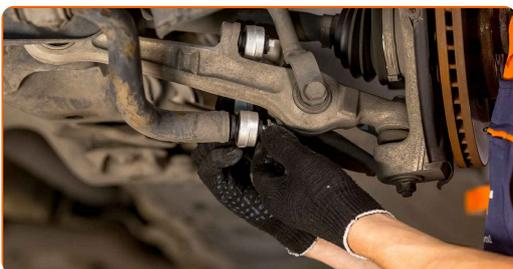
**14** Serra gli elementi di fissaggio del tirante della barra stabilizzatrice. Utilizza una chiave combinata N°16.
