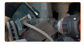
Pulisci gli elementi di fissaggio che collegano il giunto sferico al braccio di controllo della sospensione. Usa una spazzola metallica. Usa lo spray WD-40.
