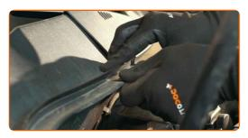
Installa la guarnizione griglia sottoparabrezza.
