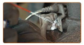
Svitare la staffa di fissaggio del tubo flessibile freno dal supporto di ammortizzazione. Utilizza una chiave combinata N°10.
