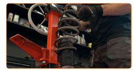
Rimuovi il parapolvere e il paracolpi dell'ammortizzatore.
