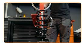
Installare il parapolvere e il limitatore flessione dinamica sul nuovo ammortizzatore.
