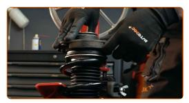
Serrare la vite dell'asta pistone supporto ammortizzazione. Utilizza una chiave a bussola N°21. Usa una chiave HEX N.H7. Usa una chiave dinamometrica. Serralo fino allo coppia di torsione di 60 Nm.
