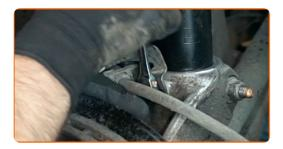
Serrare il perno di fissaggio inferiore del supporto di ammortizzazione. Utilizza una chiave a bussola N°18. Usa la chiave XZN n.14. Usa una chiave a cricchetto. Usa una chiave dinamometrica. Serralo fino allo coppia di torsione di 70 Nm. +90°
