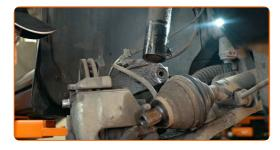
29 Svita gli elementi di fissaggio superiori del puntone dell'ammortizzatore.
