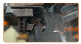
Stringere gli elementi di fissaggio che collegano il giunto sferico al braccio di controllo. Utilizza una chiave a bussola N°16. Usa una chiave dinamometrica. Serralo fino allo coppia di torsione di 60 Nm.
