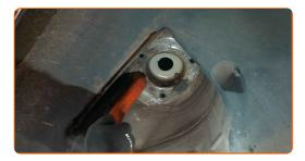
Installare il supporto di ammortizzazione nell'arco passaruota.
