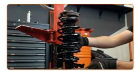
Pulisci le sedi di montaggio del puntone dell'ammortizzatore. Usa una spazzola metallica. Usa lo spray WD-40.
