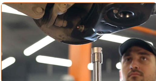
Sostituzione: braccio di controllo inferiore della sospensione posteriore - VW Passat NMS (A32, A33). AUTODOC raccomanda:
