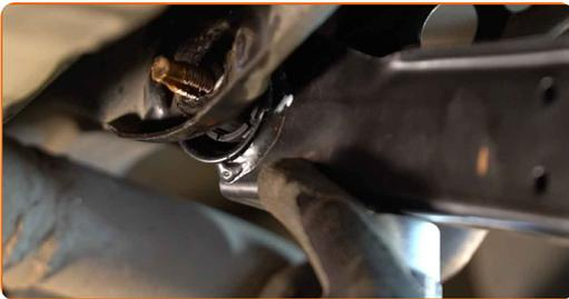
Sostituzione: braccio di controllo inferiore della sospensione posteriore - VW Passat NMS (A32, A33). I professionisti raccomandano:
