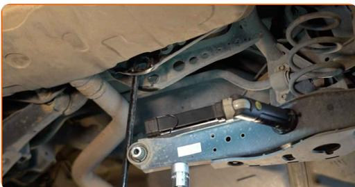
Sostituzione: braccio di controllo inferiore della sospensione posteriore - VW Passat NMS (A32, A33). Il consiglio degli esperti di AUTODOC:
