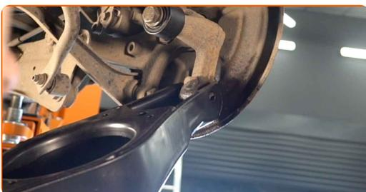
Sostituzione: braccio di controllo inferiore della sospensione posteriore - VW Passat NMS (A32, A33). Consiglio:
