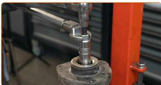
Sostituzione: ammortizzatore a molla - VW Passat CC (357). Gli esperti di AUTODOC raccomandano:
