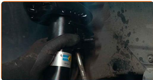
**66** Serra gli elementi di fissaggio che collegano il tirante della barra stabilizzatrice al puntone dell'ammortizzatore. Utilizza una chiave combinata N°18. Utilizza una chiave a bussola N°18. Usa la chiave XZN n.6. Usa una chiave dinamometrica. Serralo fino allo coppia di torsione di 55 Nm.
