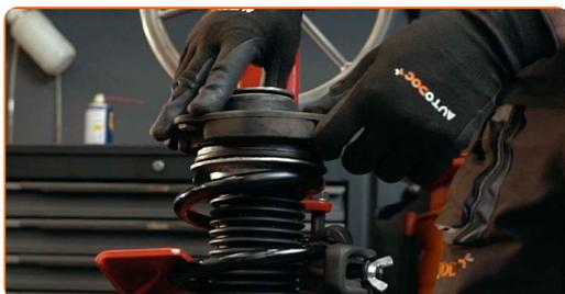
**45** Serrare la vite dell'asta pistone supporto ammortizzazione. Utilizza una chiave a bussola N°21. Usa una chiave HEX N.H7. Usa una chiave dinamometrica. Serralo fino allo coppia di torsione di 60 Nm.
