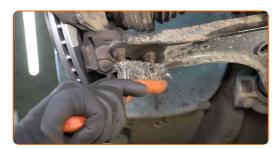
Svita gli elementi di fissaggio che collegano il giunto sferico al braccio di sospensione. Utilizza una chiave a bussola N°16. Usa una chiave a cricchetto.
