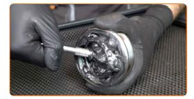
Installare il nuovo giunto omocinetico. Usare un set di montaggio/smontaggio cuscinetti e boccole. Usa un martello.
