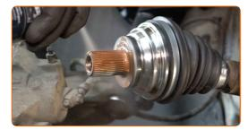
Pulisci la sede di montaggio del giunto sferico. Usa una spazzola metallica. Usa lo spray WD-40.
