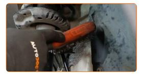
Svita gli elementi di fissaggio che collegano il tirante della barra stabilizzatrice al puntone dell'ammortizzatore. Utilizza una chiave a bussola N°19. Usa una chiave a cricchetto.
