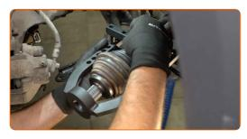
Installa il bullone dell'albero di trasmissione e serralo. Utilizza una chiave a bussola N°27. Usa una chiave a cricchetto.
