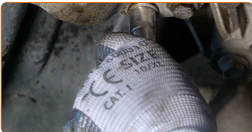
**12** Rimuovi l'elemento di fissaggio posteriore del braccio di sospensione (2 pezzi).
