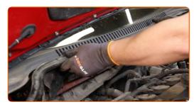
Avvitare gli elementi di fissaggio del pannello di plastica. Usa la chiave Torx T 30. Usa una chiave a cricchetto.
