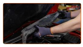
Pulisci gli elementi di fissaggio del supporto superiore del puntone dell'ammortizzatore. Usa una spazzola metallica. Usa lo spray WD-40.
