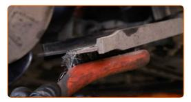
Pulire la sede di montaggio del puntone di sospensione sul fuso a snodo dello sterzo. Usa una spazzola metallica.
