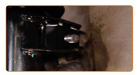
Serra gli elementi di fissaggio del tirante della barra stabilizzatrice. Utilizza una chiave a bussola N°18. Usa la chiave XZN n.6. Usa una chiave a cricchetto.
