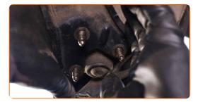
Serrare gli elementi di fissaggio che collegano il giunto sferico al braccio della sospensione. Utilizza una chiave a bussola N°16. Usa una chiave a cricchetto.
