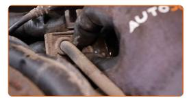
Serrare l'elemento di fissaggio che collega il supporto del tubo del freno al puntone di sospensione. Utilizza una chiave combinata N°10.
