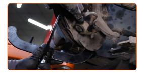
Sgancia gli elementi di fissaggio che collegano il puntone dell'ammortizzatore al fuso a snodo. Usa una chiave a bussola specifica per rimuovere l'ammortizzatore.
