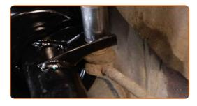
Serrare i fermi inferiori del puntone di sospensione. Utilizza una chiave a bussola N°18. Usa la chiave XZN n.14. Usa una chiave dinamometrica. Serralo fino allo coppia di torsione di 70 Nm. +90°
