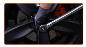
Avvita i bulloni delle ruote seguendo una sequenza incrociata diagonalmente. Usa la chiave a bussola per dadi cerchio ruota n.17. Usa una chiave dinamometrica. Serralo fino allo coppia di torsione di 120 Nm.
