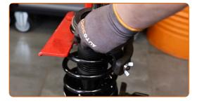
Installare il montante superiore del puntone insieme al bump stop (fine corsa).
