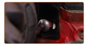
Serrare gli elementi di fissaggio del pannello di plastica. Usa la chiave Torx T 30. Usa una chiave dinamometrica. Serralo fino allo coppia di torsione di 8 Nm.
