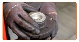
Serrare la vite dell'asta pistone supporto ammortizzazione. Utilizzare un dado a risvolto da 21 mm. Usa una chiave HEX N.H6. Usa una chiave dinamometrica. Serralo fino allo coppia di torsione di 60 Nm.
