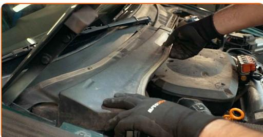
12 Installa la guarnizione griglia sottoparabrezza.
