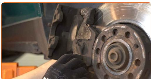
**Sostituzione: dischi freni - VW Passat B5 GP Sedan (3BG, 3B3). AUTODOC raccomanda:**
