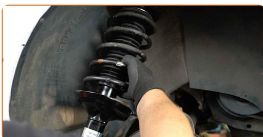
**32** Avvita l'elemento di fissaggio superiore del montante supporto ammortizzazione. Non lo serrare.
