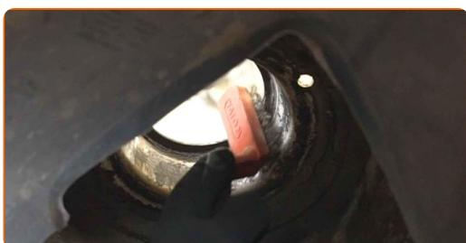
**31** Installare il supporto di ammortizzazione nell'arco passaruota.
