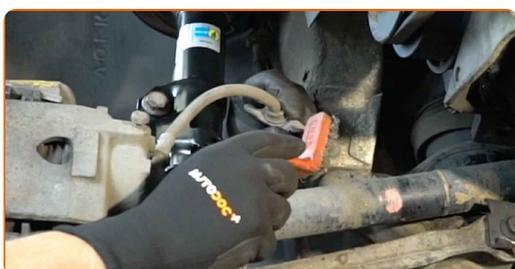
**40** Fissare la staffa di fissaggio del tubo flessibile freno.
