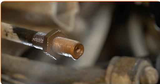
14 Avvita una nuova testa barra comando sterzo.. Usa un calibro a corsoio.
