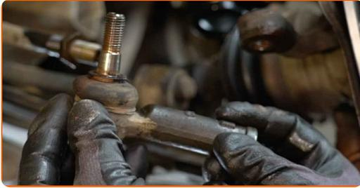
12 Pulisci le sedi di montaggio delle testine tiranti dello sterzo. Usa una spazzola metallica. Usa un detergente spray multiuso.
