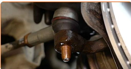
**17** Avvita il dado di serraggio che collega le testine tiranti dello sterzo al fuso a snodo. Utilizza una chiave a bussola N°19. Usa una chiave a cricchetto.
