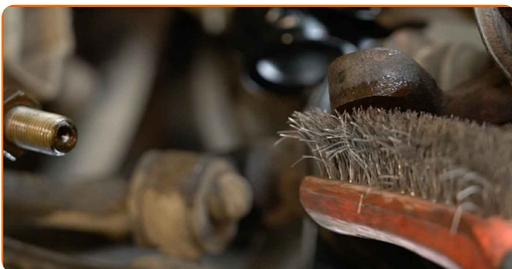
13 Tratta con del prodotto le sedi di montaggio delle testine tiranti dello sterzo. Usa il grasso al rame.
