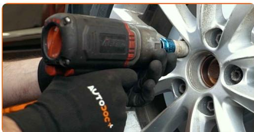
21 Rimettere il veicolo per terra e, lavorando in ordine incrociato, serrare i bulloni di fissaggio delle ruote. Usa la chiave a bussola per dadi cerchio ruota n.17. Usa una chiave dinamometrica. Serralo fino allo coppia di torsione di 120 Nm.
