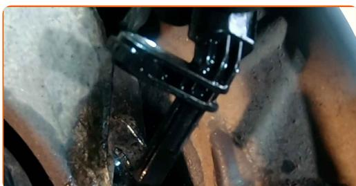
**10** Pulire la sede di montaggio del sensore ABS. Usa una spazzola metallica. Usa lo spray WD-40.
