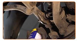
62 Installa il puntone stabilizzatore trasversale.
