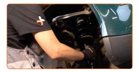
Avvita l'elemento di fissaggio superiore del montante supporto ammortizzazione. Utilizza una chiave a bussola N°15. Usa una chiave a cricchetto. Non lo serrare.
