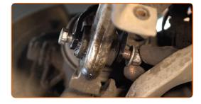
Avvita l'elemento di fissaggio inferiore del puntone dell'ammortizzatore. Utilizza una chiave combinata N°18. Utilizza una chiave a bussola N°18.
