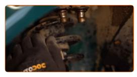
Pulisci gli elementi di fissaggio dei tiranti delle barre stabilizzatrici. Usa una spazzola metallica. Usa lo spray WD-40.
