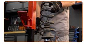
Rimuovi il parapolvere e il paracolpi dell'ammortizzatore.
