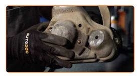
Stringi l'elemento di fissaggio superiore del supporto di ammortizzazione. Utilizza una chiave a bussola N°13. Usa una chiave dinamometrica. Serralo fino allo coppia di torsione di 22 Nm.
