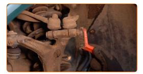
Svitare gli elementi di fissaggio della leva di manovra superiore (2 pezzi). Utilizza una chiave combinata N°16. Utilizza una chiave a bussola N°16.
