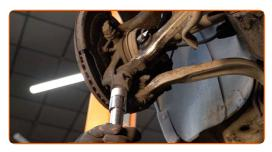
Serrare il perno di fissaggio inferiore del supporto di ammortizzazione. Utilizza una chiave combinata N°18. Utilizza una chiave a bussola N°18. Usa una chiave dinamometrica. Serralo fino allo coppia di torsione di 90 Nm.
