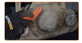
Allenta gli elementi di fiìssaggio superiori del supporto dell'ammortizzatore. Utilizza una chiave a bussola N°13.
