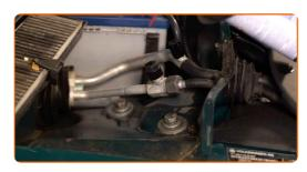
Allenta gli elementi di fiìssaggio superiori del supporto dell'ammortizzatore. Utilizza una chiave a bussola N°16. Usa una chiave a cricchetto.
