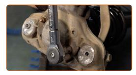
Installare il supporto di ammortizzazione nell'arco passaruota.
