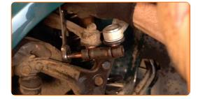
Avvitare gli elementi di fissaggio (2 pezzi) del braccio di controllo superiore. Utilizza una chiave combinata N°16. Utilizza una chiave a bussola N°16.
