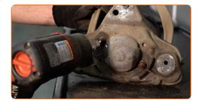
Rimuovere il supporto dell'ammortizzatore superiore assemblato con i bracci di controllo.
