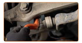
Svita gli elementi di fissaggio che collegano il tirante della barra stabilizzatrice alla barra. Utilizza una chiave combinata N°16 (2 pezzi).
