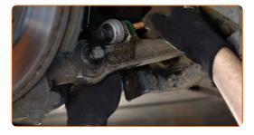
Serra l'elemento di fissaggio che collega la barra stabilizzatrice con il braccio di sospensione. Utilizza una chiave combinata N°16. Utilizza una chiave a bussola N°16. Usa una chiave dinamometrica. Serralo fino allo coppia di torsione di 40 Nm. +90°
