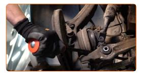
24 Svita l'elemento di fissaggio superiore del montante supporto ammortizzazione.
