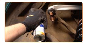
Collega il braccio di controllo superiore al fuso a snodo (2 pezzi).
