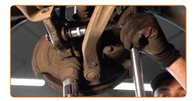
Serrare gli elementi di fissaggio della leva di manovra superiore (2 pezzi). Utilizza una chiave combinata N°16. Utilizza una chiave a bussola N°16. Usa una chiave dinamometrica. Serralo fino allo coppia di torsione di 40 Nm.
