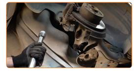
Sostituzione: ammortizzatori - VW PASSAT (3B2). Gli esperti di AUTODOC raccomandano:
