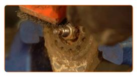
Rimuovere l'elemento di fissaggio dell'asta pistone ammortizzatore. Usa la chiave a bussola per ammortizzatore N°5. Utilizza una chiave a bussola N°17. Usa una chiave a cricchetto.
