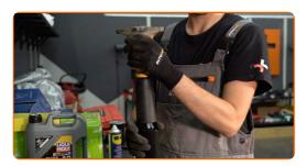
Avvitare il fissaggio superiore dell'asta pistone ammortizzatore. Utilizza una chiave combinata N°17. Utilizza le pinze di autobloccanti. Usa una chiave dinamometrica. Serralo fino allo coppia di torsione di 25 Nm.
