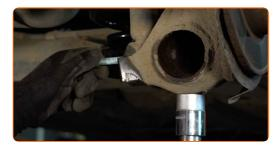
Rimuovi il supporto da sotto la trave dell'asse posteriore.
