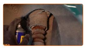
Svita l'elemento di fissaggio superiore dell'ammortizzatore. Utilizza una chiave a bussola N°13. Usa una chiave a cricchetto.
