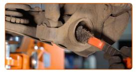
Sostieni la traversa posteriore della sospensione. Usa un cric idraulico per trasmissione.
