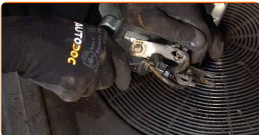
**22** Fissare la staffa di fissaggio del tubo flessibile freno. Utilizza una chiave a bussola N°11. Usa una chiave a cricchetto.
