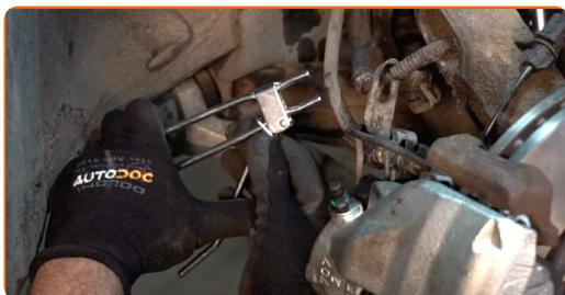
**29** Collegare il connettore elettrico del sensore ABS. Collegare la presa del sensore di usura delle pastiglie dei freni.
