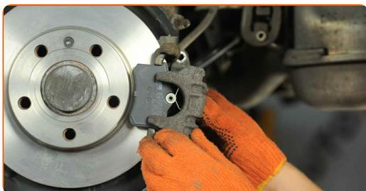
**20** Monta i bulloni di fissaggio (2 pezzi).
