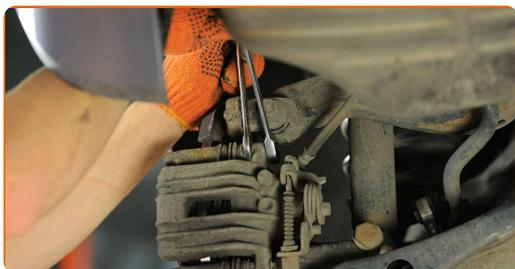
**9** Rimuovi i bulloni di fissaggio (2 pezzi).
