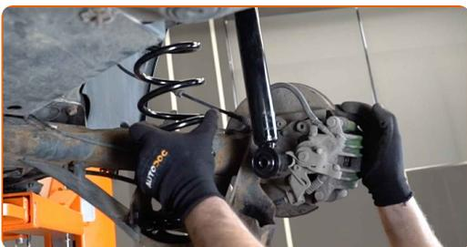
**19** Fissare la trave asse posteriore. Usa un cric idraulico per trasmissione.
