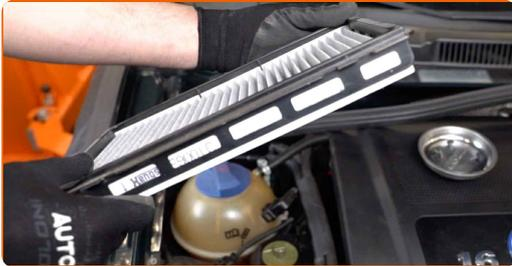
Sostituzione: filtro antipolline - VW New Beetle Hatchback (9C1, 1C1). Il consiglio di AUTODOC:
