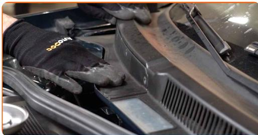
11 Avvita gli elementi di fissaggio del coperchio del filtro abitacolo. Usa un cacciavite Phillips.
