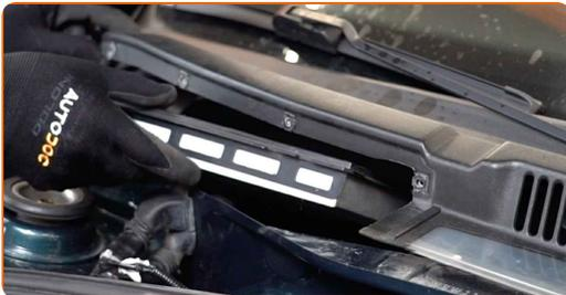
Sostituzione: filtro antipolline - VW New Beetle Hatchback (9C1, 1C1). Gli esperti di AUTODOC raccomandano:
