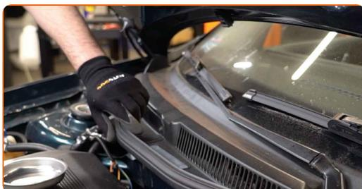
13 Rimuovi la copertura di protezione del parafrango.
