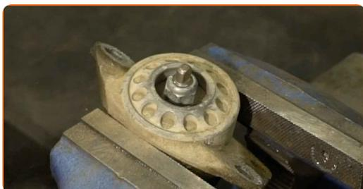
**15** Pulisci l'elemento di fissaggio dell'asta dell'ammortizzatore. Usa una spazzola metallica. Usa lo spray WD-40.
