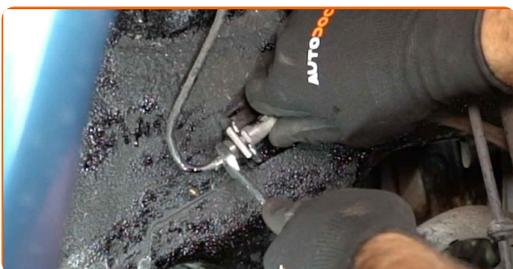
**14** Rimuovi il clip di ritenuta del tubo flessibile del freno. Usa un piede di porco.
