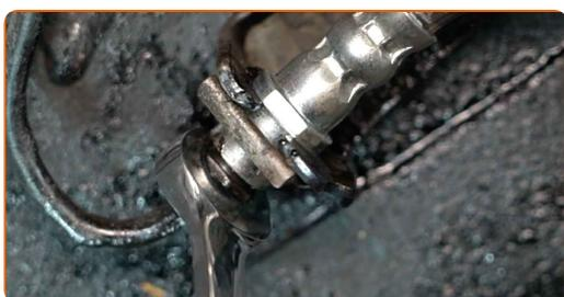
**21** Installa il tubo flessibile del freno al clip di ritenuta. Usa un martello.
