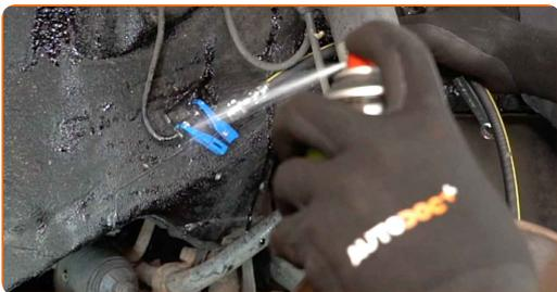
Sostituzione: tubi freno - VW New Beetle Cabrio (1Y7). Il consiglio di AUTODOC:
