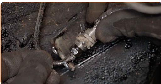
**16** Rimuovi la fascetta di fissaggio del tubo freni.
