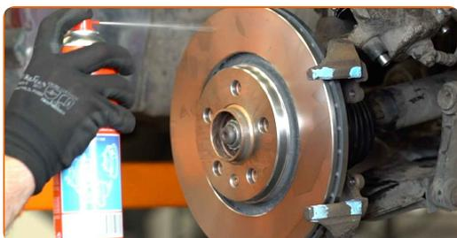
Sostituzione: dischi freni - VW New Beetle Cabrio (1Y7). Il consiglio degli esperti di AUTODOC:
