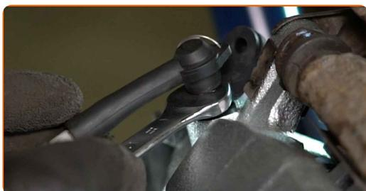
**29** Disconnetti il tubo flessibile del kit di spurgo freno pneumatico.
