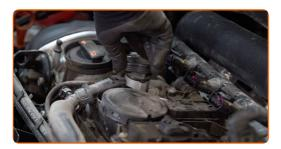
Tratta il connettore delle bobine di accensione con uno spray per dispositivi elettronici. Lo spray proteggerà i contatti elettrici dalla corrosione, l'ossidazione e la resistenza di contatto.
