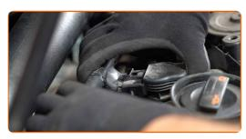
Montare il coperchio motore e fissarlo. Assicurati di sentire un clic indicante che si trova installato saldamente.
