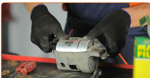
Sostituzione: filtro carburante - VW Maggiolino. AUTODOC raccomanda:
