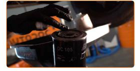
Avvitare il nuovo filtro nella posizione di lavoro. Utilizza una chiave a bussola N°32. Usa una chiave dinamometrica. Serralo fino alla coppia di torsione di 25 Nm.
