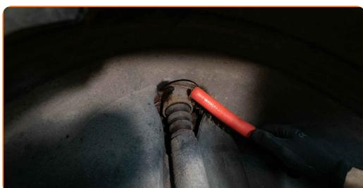
**7** Puntellare il braccio. Usa un cric idraulico per trasmissione.
