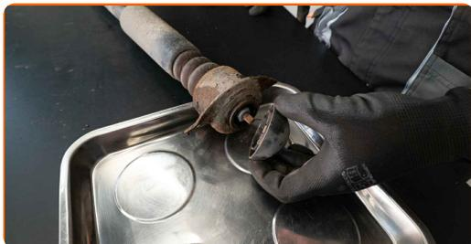
**13** Pulisci l'elemento di fissaggio dell'asta dell'ammortizzatore. Usa una spazzola metallica. Usa lo spray WD-40.
