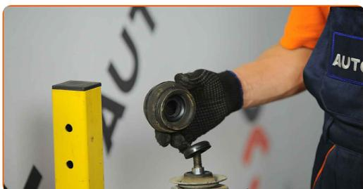
Sostituzione: supporto ammortizzatore - VW load up! Van (121, 122, BL1, BL2).
