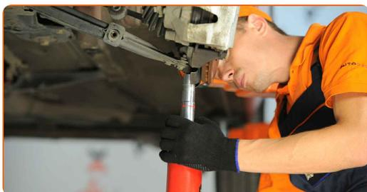
**37** Fissare il supporto di ammortizzazione sul fuso a snodo. Usa un martello.
