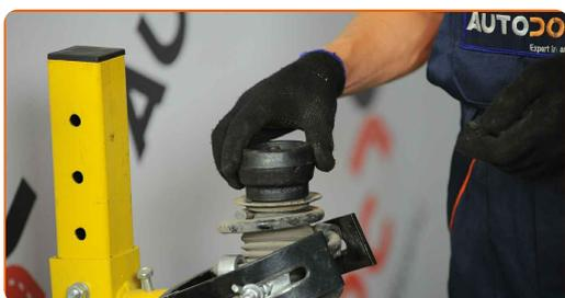
**27** Serrare la vite dell'asta pistone supporto ammortizzazione. Utilizza una chiave a bussola N°20. Usa una chiave dinamometrica. Serralo fino allo coppia di torsione di 60 Nm.
