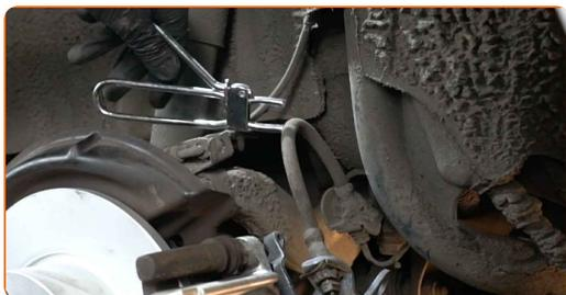
**30** Collega il tubo flessibile del kit di spurgo freno pneumatico alla valvola di spurgo del freno.
