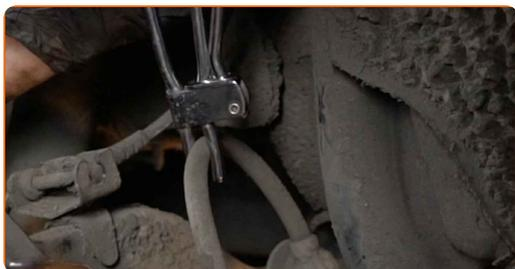
**12** Metti un contenitore per la raccolta del fluido freni al di sotto.
