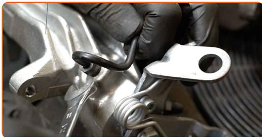
**24** Montare la pinza del freno e fissarla. Utilizza una chiave combinata N°13. Utilizza una chiave combinata N°15.
