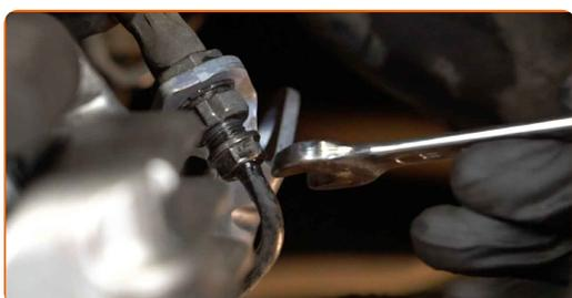
**28** Installa il tubo flessibile del freno al clip di ritenuta. Usa un martello di gomma.
