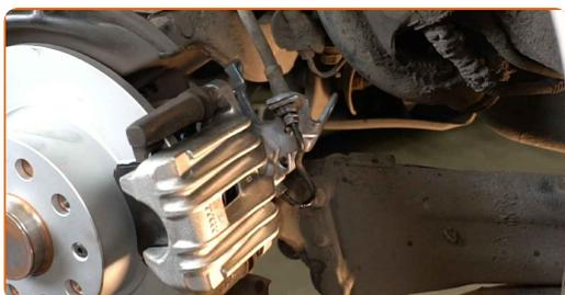
**29** Rimuovi la fascetta di fissaggio del tubo freni.
