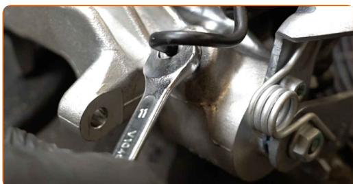
**23** Avvita l'elemento di fissaggio che collega il tubo del freno alla pinza freno. Utilizza una chiave combinata N°11.
