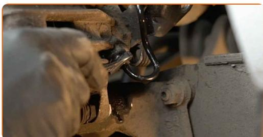
**15** Rimuovi il clip di ritenuta del tubo flessibile del freno. Usa un piede di porco.
