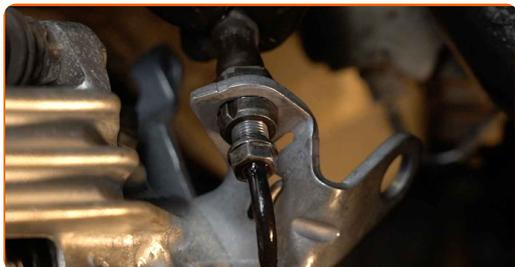
**27** Avvita l'elemento di fissaggio che collega il tubo del freno al tubo flessibile del freno. Utilizza una chiave combinata N°11.
