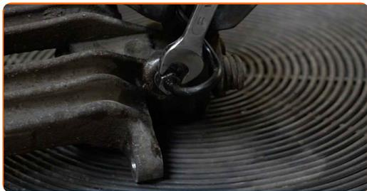
**20** Staccare il tubo del freno dalla pinza del freno.
