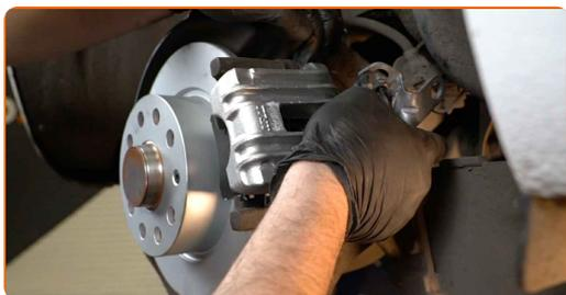
**25** Tratta con del prodotto il tubo flessibile del freno. Tratta con del prodotto il tubo del freno. Usa un pulitore freni.
