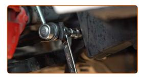
Serra gli elementi di fissaggio che collegano il tirante della barra stabilizzatrice al puntone dell'ammortizzatore. Utilizza una chiave combinata N°18. Usa la chiave XZN n.6. Usa una chiave dinamometrica. Serralo fino allo coppia di torsione di 65 Nm.
