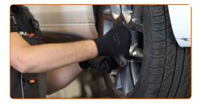
Rimettere il veicolo per terra e, lavorando in ordine incrociato, serrare i bulloni di fissaggio delle ruote. Usa una chiave dinamometrica. Serralo fino allo coppia di torsione di 120 Nm.
