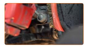
Svita gli elementi di fissaggio che collegano il tirante della barra stabilizzatrice alla barra. Utilizza una chiave combinata N°18. Usa la chiave XZN n.6. Usa una chiave a cricchetto.
