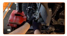
Serra gli elementi di fissaggio che collegano il tirante della barra stabilizzatrice alla barra. Utilizza una chiave combinata N°18. Usa la chiave XZN n.6. Usa una chiave dinamometrica. Serralo fino allo coppia di torsione di 65 Nm.
