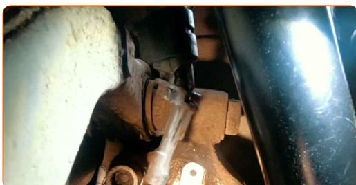
9 Scollega il connettore del sensore di velocità ABS.
