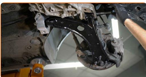
16 Installa l'elemento di fissaggio posteriore del braccio.
