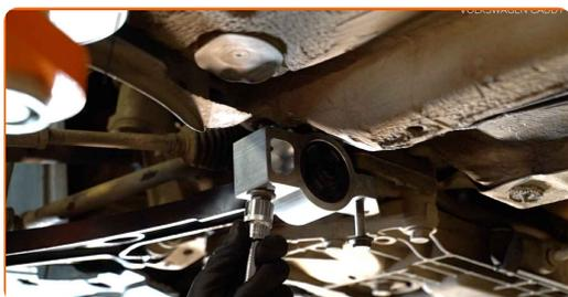
**Sostituzione: braccio inferiore anteriore - VW Jetta Mk5 (1K). AUTODOC raccomanda:**
