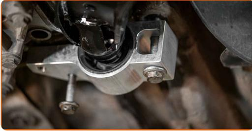
17 Puntellare il braccio. Usa un cric idraulico per trasmissione.
