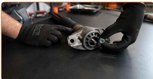
**17** Avvitare il fissaggio superiore dell'asta pistone ammortizzatore. Utilizza una chiave combinata N°16. Usa una chiave regolabile. Usa una chiave dinamometrica. Serralo fino allo coppia di torsione di 25 Nm.
