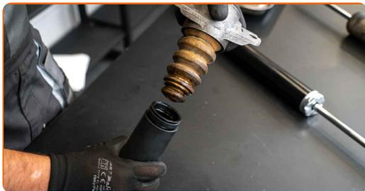
**16** Installa il supporto montante superiore dell'ammortizzatore.
