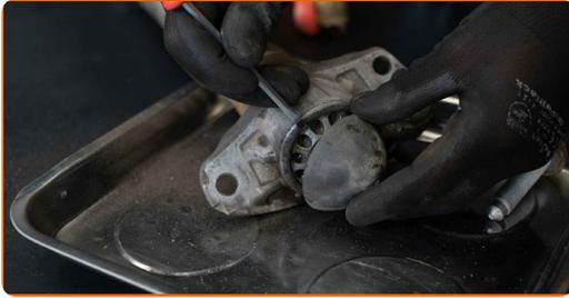
**13** Rimuovere l'elemento di fissaggio dell'asta pistone ammortizzatore. Utilizza una chiave combinata N°16. Usa una chiave regolabile.
