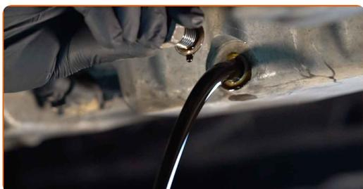
Sostituzione: olio motore e filtro - VW Jetta Mk2 (19E, 1G2, 165). Il consiglio di AUTODOC:
