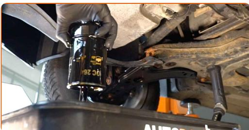
Sostituzione: olio motore e filtro - VW Jetta Mk2 (19E, 1G2, 165). Il consiglio degli esperti di AUTODOC:
