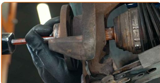
Sostituzione: cuscinetto ruota - VW Jetta II (19E, 1G2, 165). AUTODOC raccomanda:
