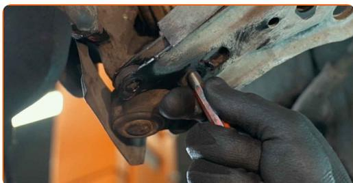
**48** Avvitare l'elemento di fissaggio che collega il giunto sferico al braccio di controllo. Utilizza una chiave a bussola N°13. Usa una chiave a cricchetto.
