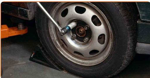
**4** Allenta l'elemento di fissaggio dell'albero di trasmissione. Utilizza una chiave a bussola N°30. Usa un giramaschi.
