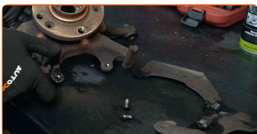
**30** Estrarre il mozzo della ruota dal fuso a snodo. Usare un set di montaggio/smontaggio cuscinetti e boccole.
