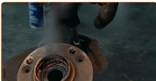
**29** Rimuovi la lamiera di protezione del disco freno.
