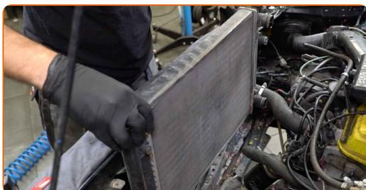
**18** Svitare gli elementi di fissaggio delle guide d'aria del radiatore. Utilizza una chiave a bussola N°10. Usa una chiave a cricchetto.
