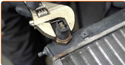
**21** Avvitare e stringere il sensore di temperatura del liquido di raffreddamento. Usa una chiave regolabile. Usa una chiave dinamometrica. Serralo fino allo coppia di torsione di 16 Nm.
