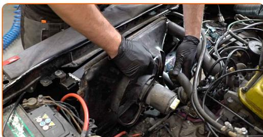
**32** Avvitare gli elementi di fissaggio dell'alloggiamento della ventola. Utilizza una chiave a bussola N°10. Usa una chiave a cricchetto.
