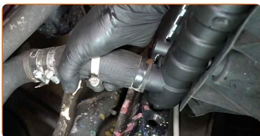
**29** Fissare il morsetto del tubo di raffreddamento. Utilizza una chiave a bussola N°7. Usa una chiave a cricchetto.
