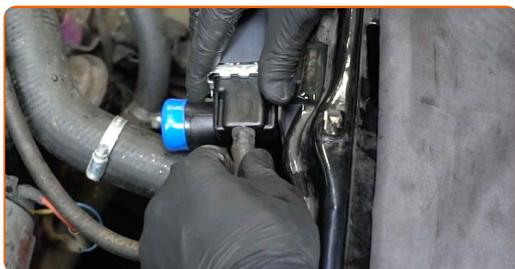
**26** Fissare il morsetto del tubo di raffreddamento. Utilizza una chiave a bussola N°7. Usa una chiave a cricchetto.
