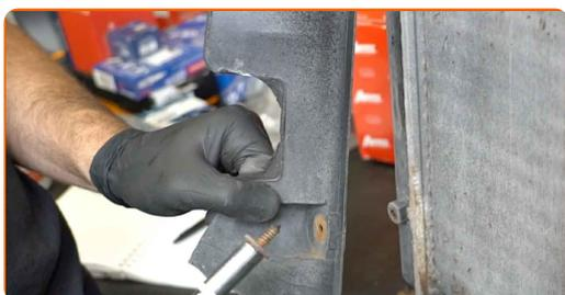
**20** Svitare il sensore di temperatura del refrigerante. Usa una chiave regolabile.
