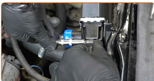
**27** Stringere gli elementi di fissaggio del radiatore. Utilizza una chiave a bussola N°10. Usa una chiave dinamometrica. Serralo fino allo coppia di torsione di 14 Nm.
