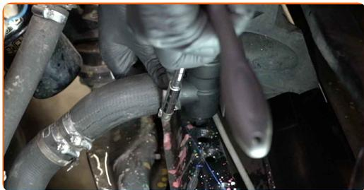
**30** Inserire il connettore del sensore di temperatura del fluido di raffreddamento.
