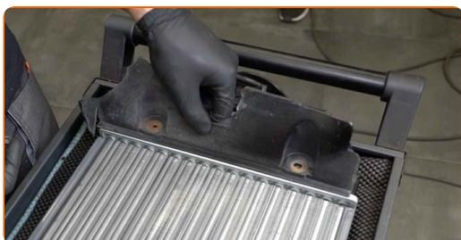
**23** Avvitare gli elementi di fissaggio delle guide dell'aria del radiatore. Utilizza una chiave a bussola N°10. Usa una chiave a cricchetto.
