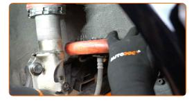
Stringi il tubo del freno usando una fascetta di fissaggio del tubo freni.
