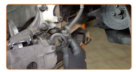
Pulisci l'area in cui il tubo flessibile si collega alla pinza del freno e alla tubatura del circuito dei freni. Usa una spazzola metallica. Usa lo spray WD-40.
