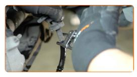
Svitare il tubo flessibile del freno dalla pinza del freno.
