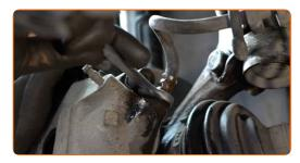
Allentare l'elemento di fissaggio che collega l'impianto dei freni al tubo flessibile del freno. Utilizza una chiave combinata N°11.
