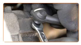
Premi il pedale del freno diverse volte per espellere l'aria dal sistema.
