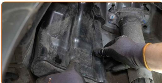
**15** Pulisci gli elementi di fissaggio del supporto superiore dell'ammortizzatore. Usa una spazzola metallica. Usa lo spray WD-40.
