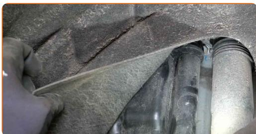
**12** Pulire l'elemento di fissaggio del contenitore per carbone attivo. Usa una spazzola metallica. Usa lo spray WD-40.
