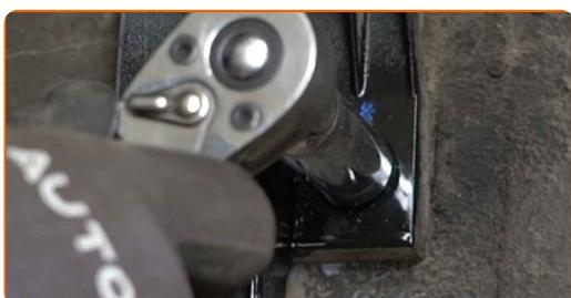
**14** Spostare il contenitore per carbone attivo in modo da avere accesso agli elementi di fissaggio dell'ammortizzatore superiore.
