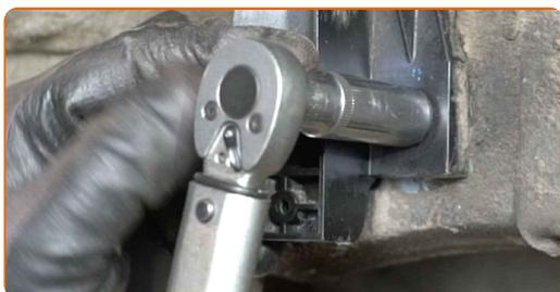
**40** Applicare un prodotto trattante all'elemento di fissaggio del contenitore per carbone attivo. Usa il grasso al rame.
