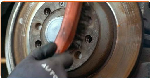
**17** Svitare l'attacco del disco freno. Usa la chiave Torx T30. Usa un cacciavite a percussione.
