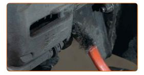
Svitare l'attacco della pinza freno. Utilizza una chiave combinata N°13. Utilizza una chiave combinata N°15. Utilizza una chiave a bussola N°13. Usa una chiave a cricchetto.
