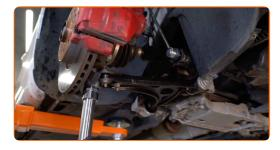
Avvita l'elemento di fissaggio anteriore del braccio. Utilizza una chiave a bussola N°18. Usa una chiave dinamometrica. Serralo fino allo coppia di torsione di 70 Nm. +180°
