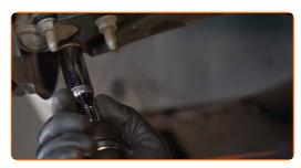
Svita gli elementi di fissaggio posteriori che collegano il braccio di sospensione al sottotelaio. Utilizza una chiave a bussola N°15. Usa un giramaschi.
