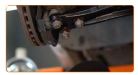
Avvita gli elementi di fissaggio del giunto sferico. Utilizza una chiave a bussola N°15. Usa una chiave a cricchetto.
