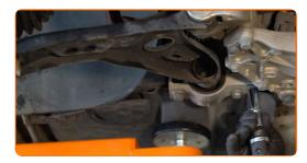
Svita gli elementi di fissaggio posteriori che collegano il braccio di sospensione alla carrozzeria. Utilizza una chiave a bussola N°18. Usa un giramaschi.
