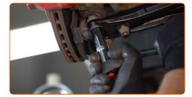
Avvita gli elementi di fissaggio posteriori che collegano il braccio di sospensione al sottotelaio. Utilizza una chiave a bussola N°15. Utilizza una chiave a bussola N°18. Usa una chiave a cricchetto.
