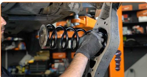
**19** Pulisci le sedi di montaggio e la filettatura del braccio di sospensione. Usa una spazzola metallica. Usa lo spray WD-40.
