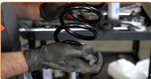
**18** Installa la molla elicoidale insieme ai montanti di gomma nelle sedi di montaggio.
