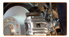
Pulisci gli elementi di fissaggio della pinza freno. Usa un pulitore freni.
