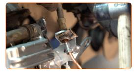
Avvita l'elemento di fissaggio che collega il tubo del freno al tubo flessibile del freno. Utilizza una chiave combinata N°13.
