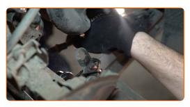
Svita l'elemento di fissaggio che collega il tubo del freno al tubo flessibile del freno. Utilizza una chiave combinata N°13.
