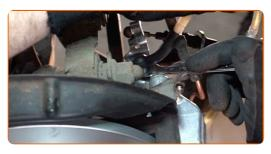
Spurgare la pinza del freno. Senza avviare il motore, premere il pedale del freno più volte finché non viene percepita una resistenza significativa.
