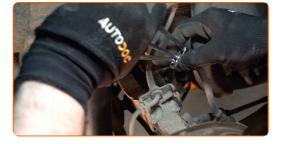
Metti un contenitore per la raccolta del fluido freni al di sotto.
