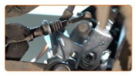
Fissa il cavo del freno di stazionamento con il clip di fissaggio.
