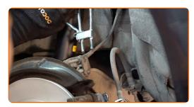
Installa il cavo del freno di stazionamento nella staffa della pinza del freno. Usa le pinze per pompa ad acqua.
