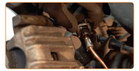
Rimuovi il clip di fissaggio del cavo del freno a mano. Usa un piede di porco.
