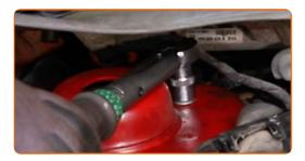
Tratta con del prodotto gli elementi di fissaggio del supporto del puntone dell'ammortizzatore. Usa il grasso al rame.
