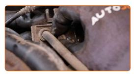
Serrare l'elemento di fissaggio che collega il supporto del tubo del freno al puntone di sospensione. Utilizza una chiave combinata N°10.
