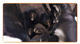
Serrare gli elementi di fissaggio che collegano il giunto sferico al braccio della sospensione. Utilizza una chiave a bussola N°16. Usa una chiave a cricchetto.
