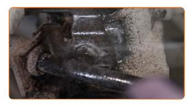
Svitare l'elemento di fissaggio che collega il supporto del tubo del freno al puntone di sospensione. Utilizza una chiave combinata N°10.
