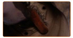
Pulisci le scanalature del giunto omocinetico dell'albero di trasmissione. Usa una spazzola metallica. Usa lo spray WD-40.
