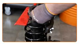
Installare il montante superiore del puntone insieme al bump stop (fine corsa).
