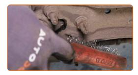
Svitare gli elementi di fissaggio che collegano il giunto sferico al braccio di controllo. Utilizza una chiave a bussola N°16. Usa una chiave a cricchetto.
