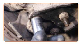
Installa il puntone stabilizzatore trasversale.
