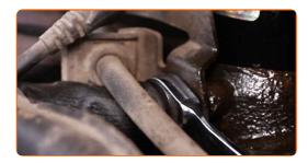
Serrare la staffa di fissaggio del tubo flessibile freno sul supporto di ammortizzazione. Utilizza una chiave a bussola N°10. Usa una chiave dinamometrica. Serralo fino allo coppia di torsione di 12 Nm.
