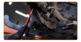
Sgancia gli elementi di fissaggio che collegano il puntone dell'ammortizzatore al fuso a snodo. Usa una chiave a bussola specifica per rimuovere l'ammortizzatore.
