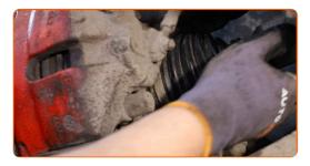
Installa il bullone dell'albero di trasmissione e serralo. Usa la chiave a bussola 12 punte n.24. Usa una chiave a cricchetto.
