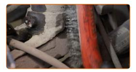
Svita gli elementi di fissaggio che collegano il puntone dell'ammortizzatore al fuso a snodo. Utilizza una chiave a bussola N°18. Usa la chiave XZN n.14. Usa una chiave a cricchetto.
