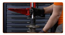
Installa il nuovo ammortizzatore sul compressore idraulico per molle.
