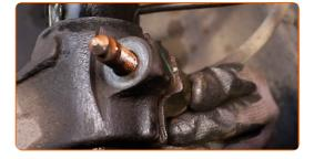
Avvita l'elemento di fissaggio che collega il puntone dell'ammortizzatore al fuso a snodo. Utilizza una chiave a bussola N°18. Usa la chiave XZN n.14. Usa una chiave a cricchetto.
